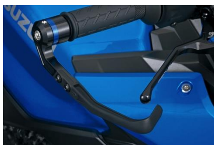
7 Protège-levier de frein En aluminium de premier choix taillé dans la masse et plastique résistant
