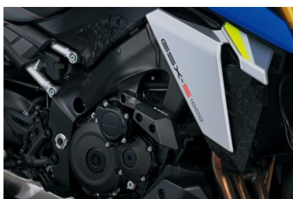
11 Sliders de cadre Réduisent les risques de casse, en aluminium et Ertacetal
