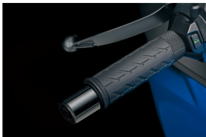
8 Poignées chauffantes Réglables sur 3 positions Surface entièrement chauffée
