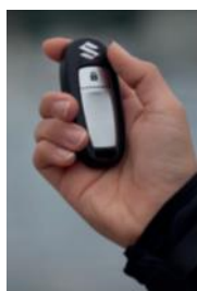
Clé sans contact du système de démarrage mains libres.
