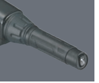
Commutateur de commande du Trim et Tilt électriques. Réglage de friction de la poignée d'accélérateur
