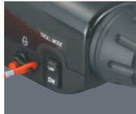
Commutateur de mode de ralenti contrôlé (troll mode) • Active le système SUZUKI Troll Mode et permet le contrôle du ralenti moteur jusqu'à 1 200 tr/min par palier de 50 tr/min.
