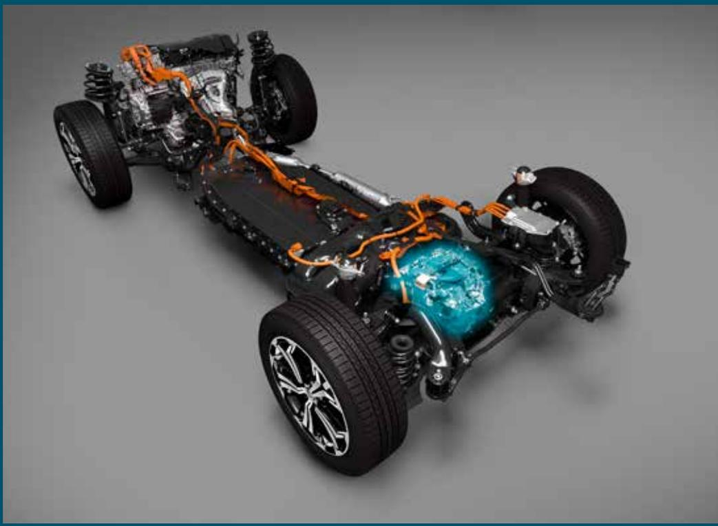
Ces modes permettent de profiter à chaque instant de la puissance du moteur 4 cylindres (185 ch) mais aussi des trois blocs électriques (180 ch), ce qui permet au ACROSS d'afficher une puissance combinée de 306 ch. Ainsi, il peut accélérer de 0 à 100 km/h en seulement 6 s, et atteindre la vitesse maximale de 180 km/h sur circuit.
