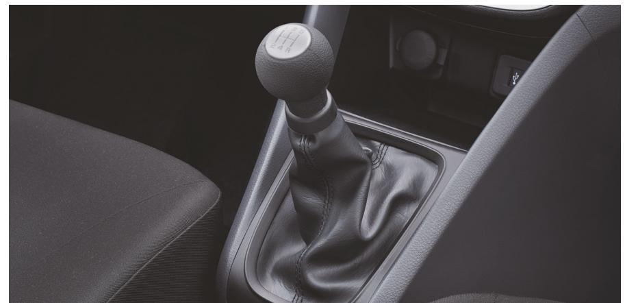
La nouvelle boîte automatique AGS (Auto Gear Shift) développée par Suzuki est constituée d'un actuateur électronique et hydraulique qui commande directement la boîte manuelle à 5 rapports et l'embrayage à la place du conducteur. De cette façon, non seulement elle apporte le confort de l'automatisme mais elle n'augmente pas la consommation de la version manuelle puisqu'il n'y a pas de convertisseur de couple hydraulique.
